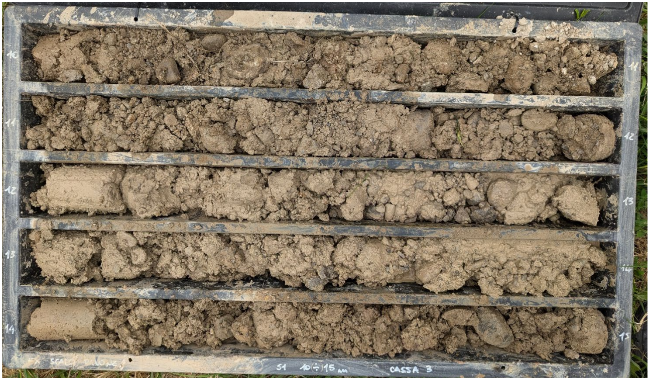
Figura 7: foto cassetta catalogatrice da -10,0 m a -15,0 m
