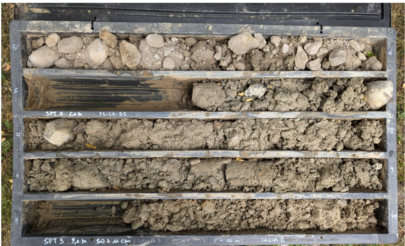
Figura 2: foto cassetta catalogatrice da -5,0 m a -10,0 m
