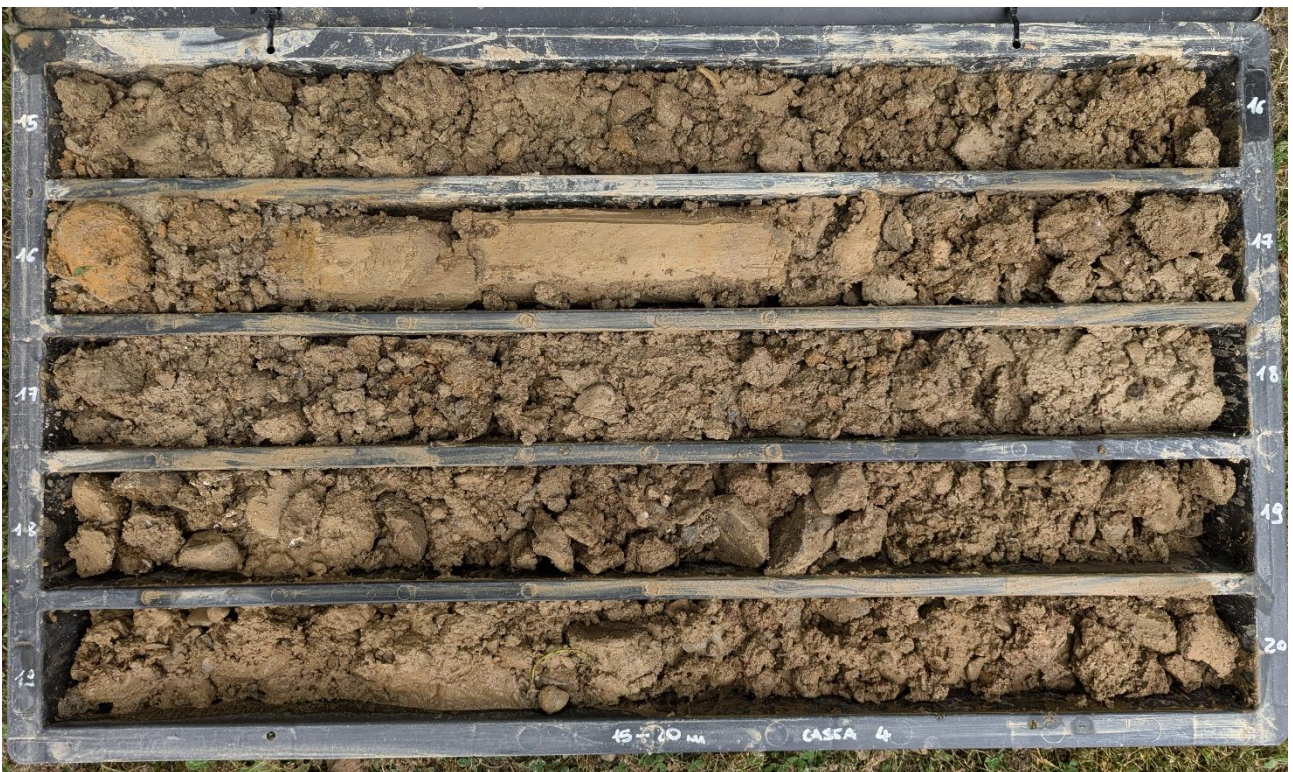
Figura 4: foto cassetta catalogatrice da -15,0 m a -20,0 m
