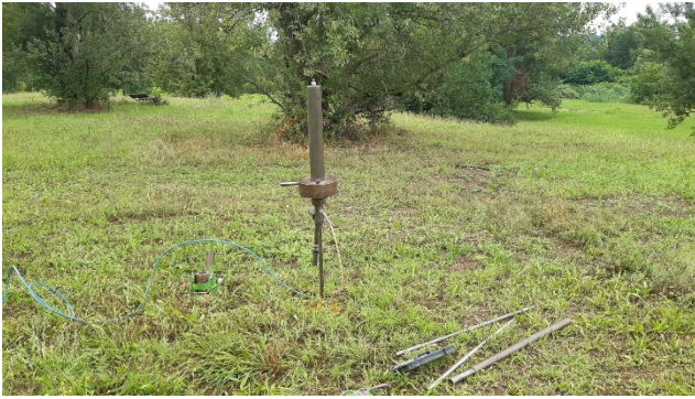
Figura 15: a sinistra posizionamento della prova DPM1 a sinistra e DPM2 a destra.
