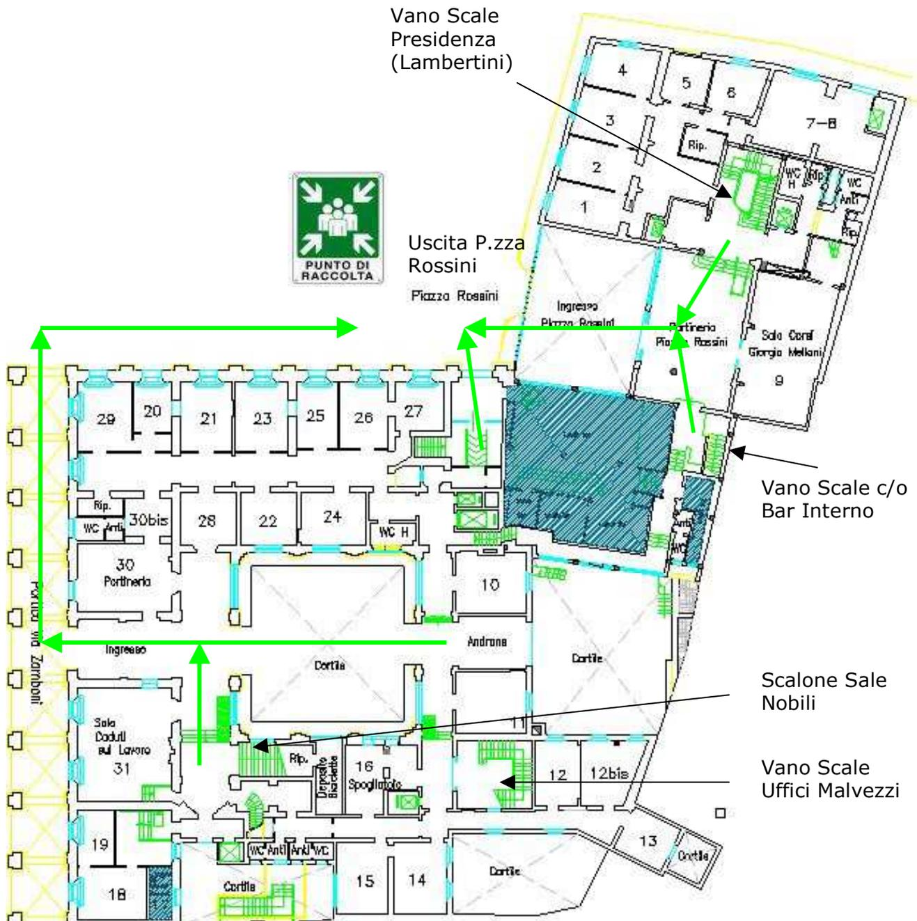
**Pianta del piano terra, localizzazione del punto di raccolta e delle principali vie d'esodo. Nelle Bacheche sono affisse le piante di evacuazione con l'indicazione di TUTTI i percorsi mentre qui sono indicate solo le vie principali**
