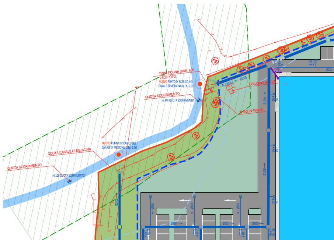
Img. 7.16 - Estratto del progetto della rete delle acque bianche (in rosso è sovrapposto il rilievo delle alberature; il tratteggio verde indica l'area afferente al Sistema delle aree forestali)
